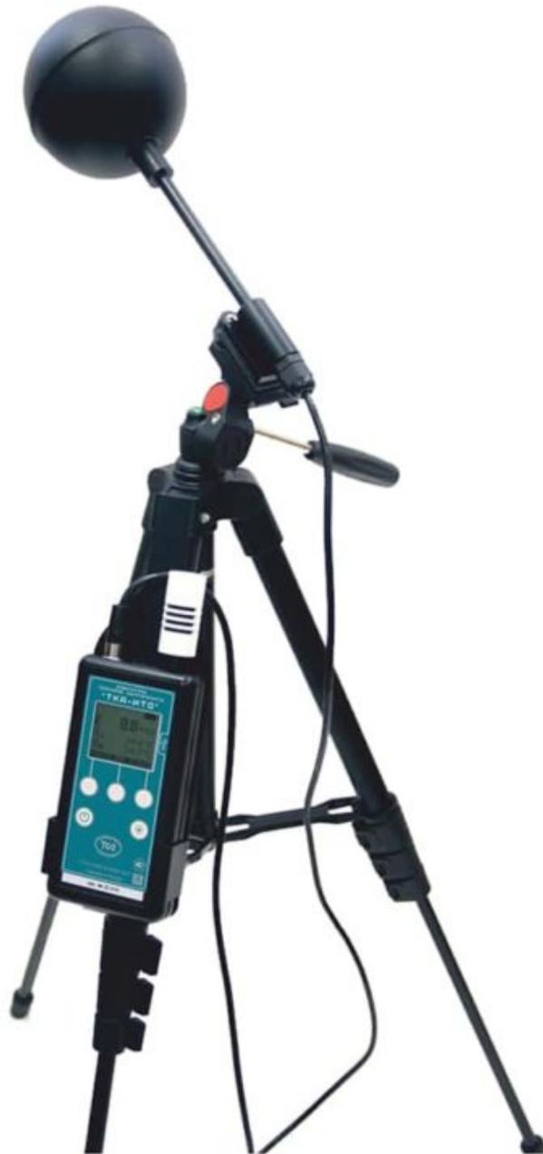
Das Funktionsprinzip des Messgeräts besteht darin, den auf die schwarze Kugel fallenden Wärmefluss in ein elektrisches Signal umzuwandeln, das proportional zur Dichte dieses Flusses (Bestrahlungsstärke) ist, gefolgt von einer Skalierung und Anzeige des Messergebnisses.
