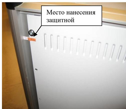
Рисунок 2 - Схема пломбирования корпуса генератора от несанкционированного доступа
