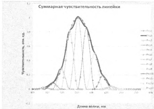
Рисунок 5 — Приведение спектральной чувствительности фотодиодной линейки к виду относительной световой эффективности глаза V(\lambda)
