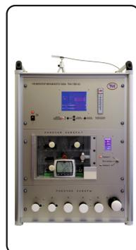
Генератор предназначен для создания паро-воздушного потока с требуемой относительной влажностью методом смешения двух потоков воздуха – сухого и влажного. Генератор выпускается по ГОСТ 8.547-09.
