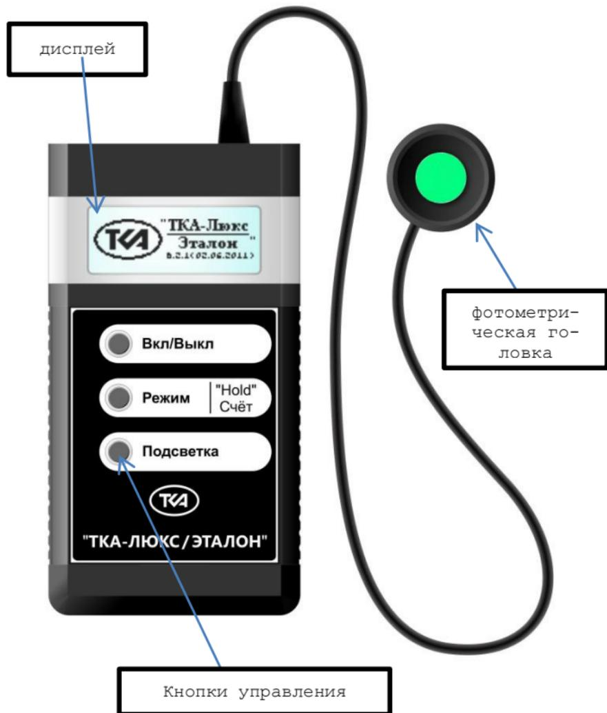
Рис. 2 Внешний вид люксметра (вид сверху)
