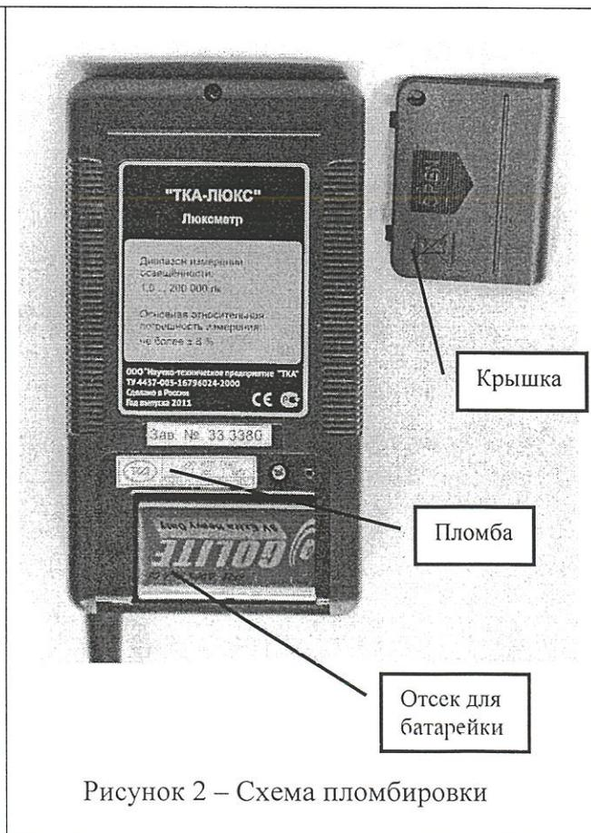
Рисунок 2 – Схема пломбировки
