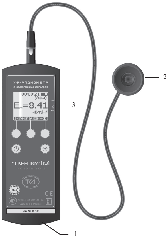
Рис.1 – Внешний вид прибора “ТКА-ПКМ”(13) 1 – Блок обработки информации 2 – Измерительная головка 3 – Технологический разъем
