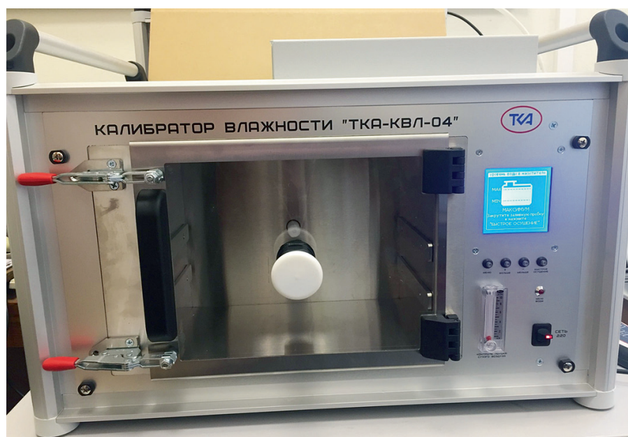
Рис. 1. Калибратор влажности «ТКА КВЛ-04К»
