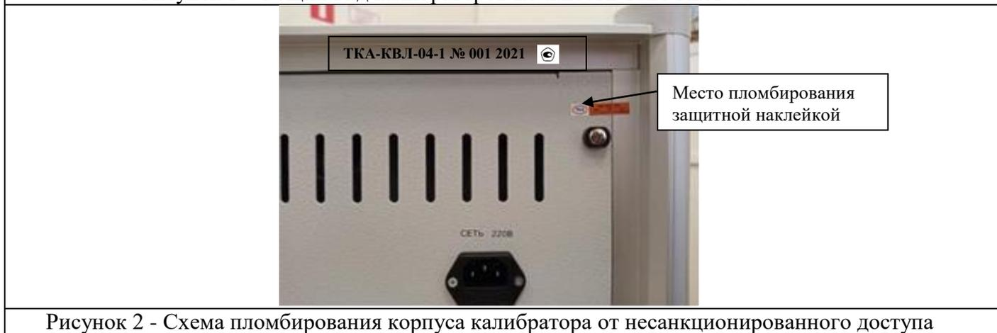
Рисунок 2 - Схема пломбирования корпуса калибратора от несанкционированного доступа
