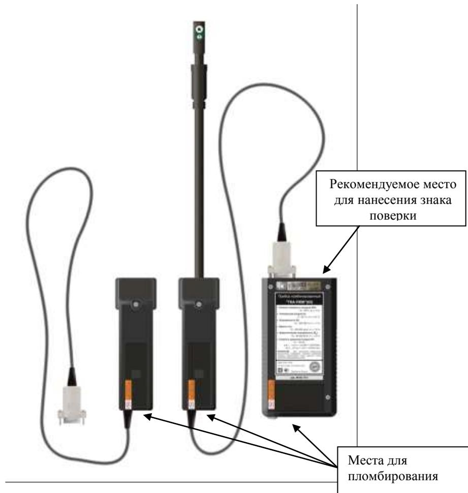
Рисунок 3.22 — Пример пломбирования приборов, вид сзади
