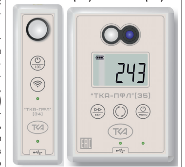
Рисунок 9. Оптические логгеры ТКА-ПФЛ(34) и ТКА-ПФЛ(35)
