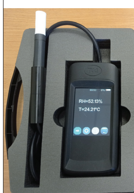
Рисунок 4. Термогигрометр эталонный ТКА –ТВ/Эталон
