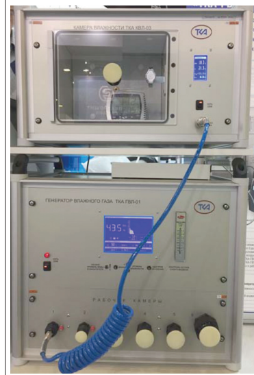
Рисунок 2. Камера влажности ТКА-КВЛ-04-2 подключена к генератору ТКА-ГВЛ-01
