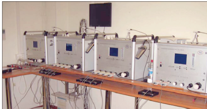
Рисунок 1. Калибровочный центр, оборудованный группой генераторов ТКА-ГВЛ-01
