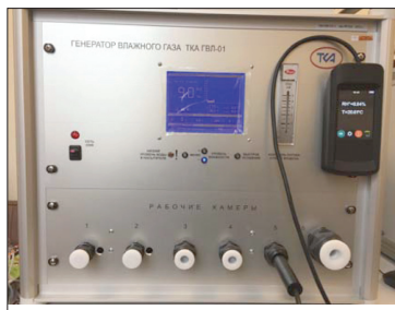
Рисунок 5. Термогигрометр эталонный ТКА –ТВ/Эталон в составе генератора влажности ТКА-ГВЛ-01
