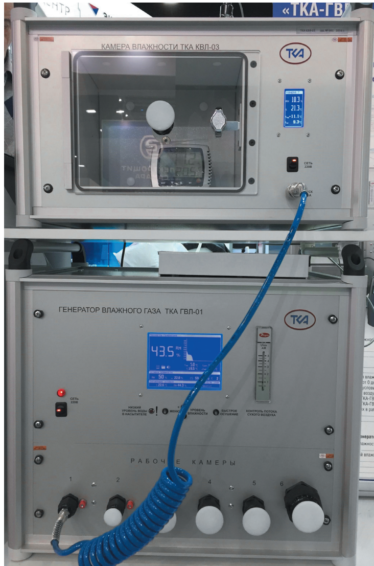
РИС. 2. ◀ Камера влажности ТКА-КВЛ-04-2 подключена к генератору ТКА-ГВЛ-01
