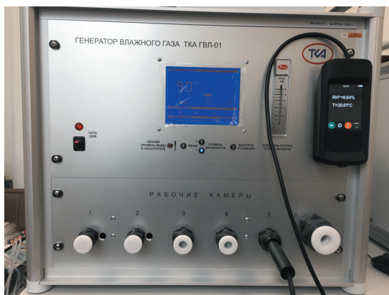
РИС. 5. ▼ Эталонный термогигрометр ТКА-ТВ/Эталон в составе генератора влажности ТКА-ГВЛ-01
