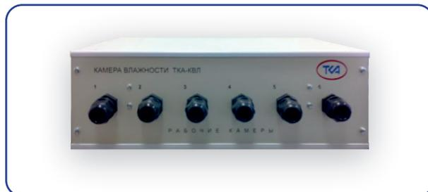
При подключении камеры влажности к выходу газовой магистрали генератора типа «ТКА-ГВЛ-01», в ней устанавливается относительная влажность газа (воздуха), уровень которой регулируется и поддерживается с помощью генератора.
