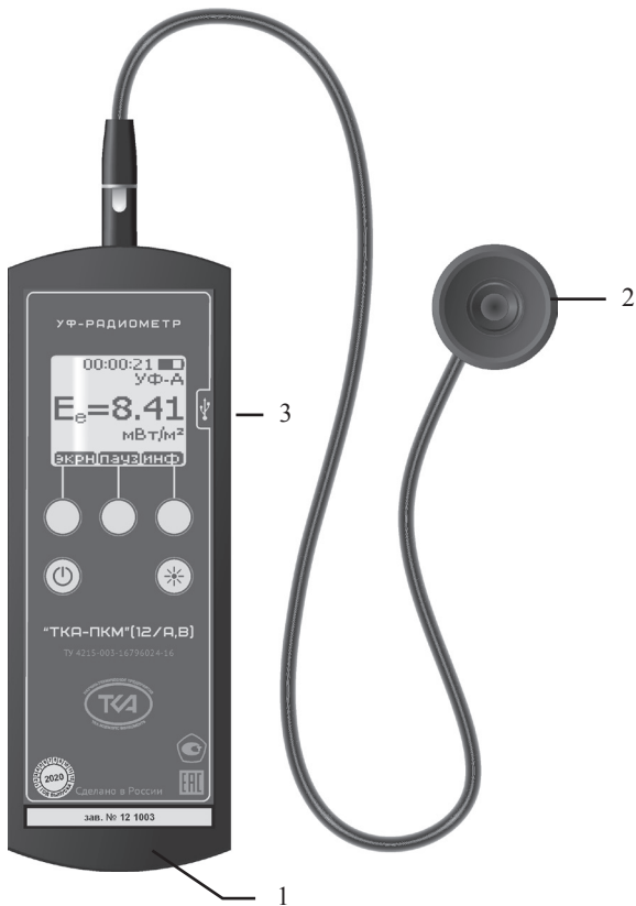
Рис.1 – Внешний вид прибора “ТКА-ПКМ”(12/А,В) 1 – Блок обработки информации 2 – Измерительная головка 3 – Технологический разъем
