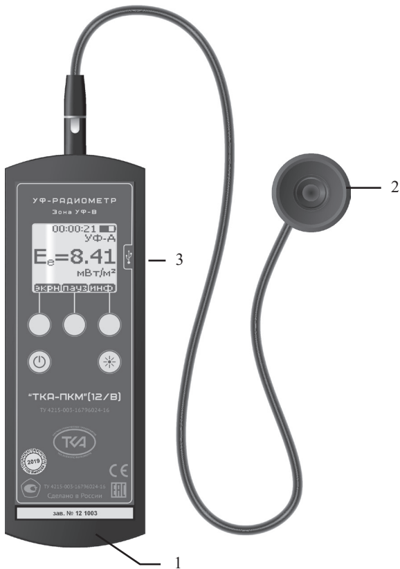
Рис.1 – Внешний вид прибора “ТКА-ПКМ”(12/В)
