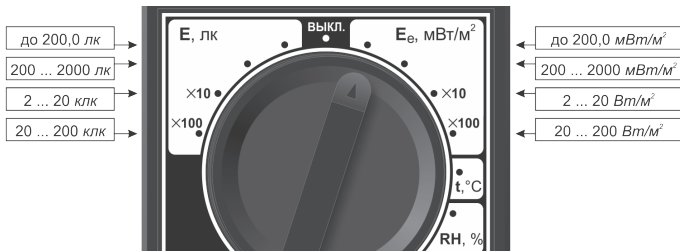
Рис.2 – Пределы измерения световых параметров
