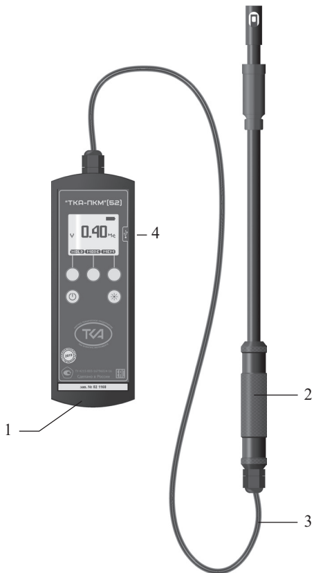
Рис.1 – Внешний вид прибора “ТКА-ПКМ”(52) 1 – Блок обработки информации 2 – Измерительная головка 3 – Кабель связи 4 – USB-разъём
