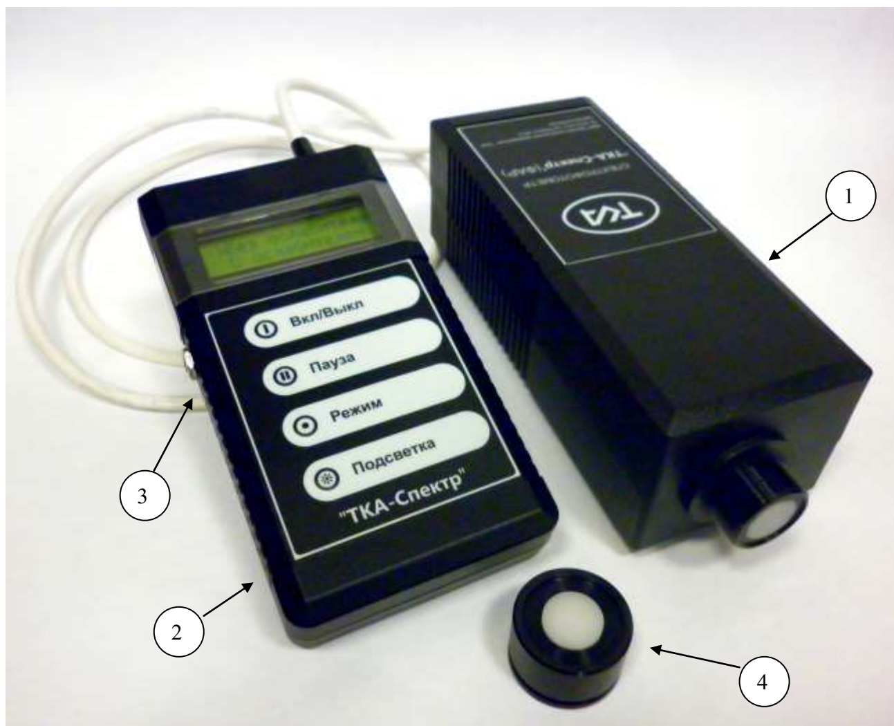
Рис. 2. Внешний вид прибора (сборка 2024 года, прошивка v.4.0.6_PAR) 1 – оптоэлектронный блок, 2 – блок обработки сигнала 3 – разъем DC IN, 4 – ослабитель (косинусный корректор-ослабитель)
