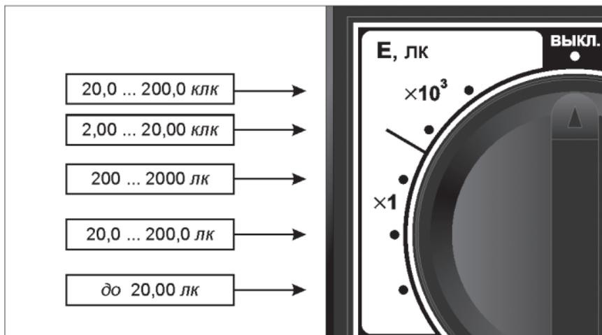
Рис.2 – Поддиапазоны измерения освещенности
