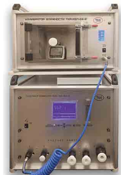
Рис. 3. Пример подключения калибратора ТКА-КВЛ-04-2 к генератору ТКА-ГВЛ-01/02
